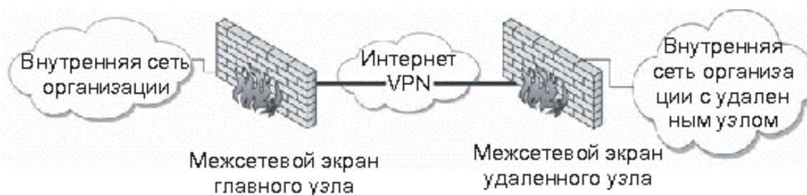
Рис. 4. Межузловое соединение VPN, проходящее через интернет
